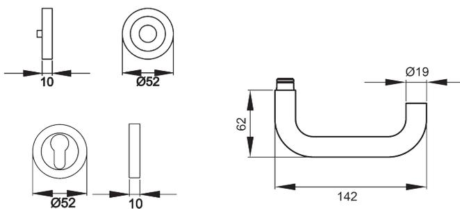
Der Türgriff Kreta ER27 hat eine zur Tür laufende Handhabe mit abgerundeten Ecken und ist somit ebenfalls für Notausgangstüren geeignet. Durch die 3-teilige Schraubrosette, wird eine einfache, schnelle und sichere Montage gewährleistet. Die edelstahlmatten Farbe unterstreicht die Formgebung dieses Griffs.
