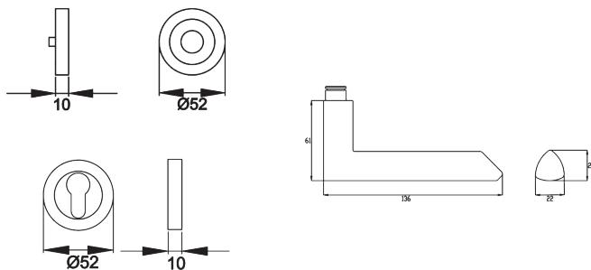
Das Modell PARIS ER55 kombiniert Ergonomie und Design auf höchstem Niveau. Das Highlight ist das abgeschrägte Ende, welches durch eine klar definierte Kante in zwei unterschiedliche Formelemente unterteilt wird. Durch die 3-teilige Schraubrosette, wird eine einfache, schnelle und sichere Montage gewährleistet. Die edelstahlmatte Farbe unterstreicht die Formgebung dieses Griffs.
