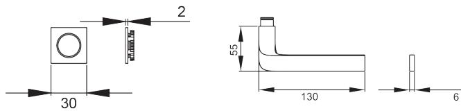
Der Türgriff Las Vegas ER87QM ist nach oben gebogen, durch klare Rundungen und eine stromlinienförmige Form definiert. Zum Griffende hin verläuft er flach. In Kombination mit der 2 mm dünnen Mini-Rosette der Mission Invisible Reihe, liegt der Fokus auf dem Türgriff selbst. Die mehrfach prämierte seidenweiche Oberfläche Kosmos Schwarz, schafft eine unvergessliche Haptik.
