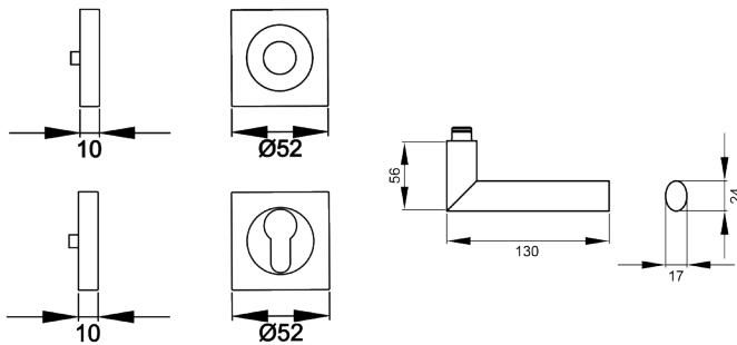
Der Türgriff Verona ER37Q zeichnet sich durch sanftere und fließende Konturen aus, was durch den ovalen Hals unterstützt wird. Durch die 3-teilige Schraubrosette, wird eine einfache, schnelle und sichere Montage gewährleistet. Mit der hochwertigen Farbe Edelstahl matt/ poliert trifft zeitlose Eleganz auf edle Optik.
