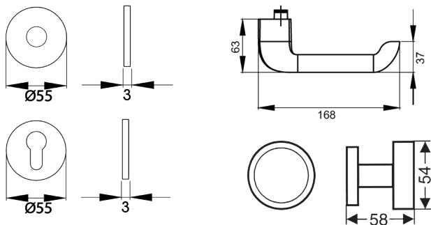
Der minimalistische Türgriff EPL96 wird von einem hochwertiger Lederüberzug ummantelt, der eine besonders angenehme Haptik verspricht. In Kombination mit der 3mm dicken Plan Design Rosette, ist eine aufgesetzte oder flächenbündige Montage möglich. Die edelstahlmatte Farbe unterstreicht die Formgebung dieses Griffs.
