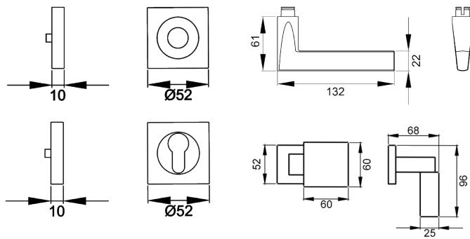
Hochwertiger Edelstahl und eine vollkommene Formsprache verleihen dem Türgriff Montana ER54Q eine hervorragende Handhabe. Die Reduktion auf geometrische Formen lassen den Türgriff elegant und zeitlos wirken. Durch die 3-teilige Schraubrosette, wird eine einfache, schnelle und sichere Montage gewährleistet. Die mehrfach prämierte seidenweiche Oberfläche Kosmos Schwarz, schafft eine unvergessliche Haptik.
