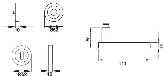
Der Türgriff TORINO R53 hat eine schlichte, rechteckige Handhabe. In die nur wenige Millimeter tiefe Aussparung auf können individuelle Insets eingeklebt werden. Durch die 3-teilige Schraubrosette, wird eine einfache, schnelle und sichere Montage gewährleistet. Eine edle Optik verleiht die Farbe Nickel matt, welche durch die Brüstung besonders charakterisiert wird.
