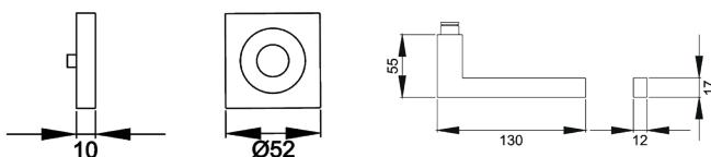
In einer Hommage an das sehr beliebte Türgriffmodell Seattle ER46Q wurde das Modell Boston ER58Q entwickelt. Hier sprechen gerade Formen für eine moderne Schlichtheit. Durch die 3-teilige Schraubrosette, wird eine einfache, schnelle und sichere Montage gewährleistet. Die edelstahlmatte Farbe unterstreicht die Formgebung dieses Griffs.
