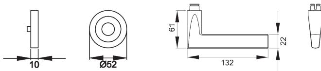
Hochwertiger Edelstahl und eine vollkommene Formsprache verleihen dem Türgriff Montana ER54 eine hervorragende Handhabe. Die Reduktion auf geometrische Formen lassen den Türgriff elegant und zeitlos wirken. Durch die 3-teilige Schraubrosette, wird eine einfache, schnelle und sichere Montage gewährleistet. Die mehrfach prämierte seidenweiche Oberfläche Kosmos Schwarz, schafft eine unvergessliche Haptik.
