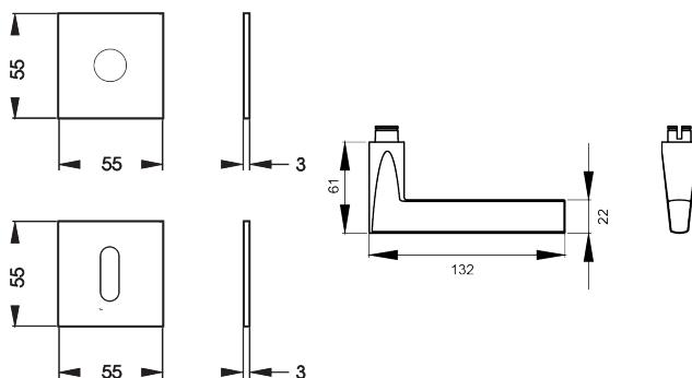
Hochwertiger Edelstahl und eine vollkommene Formsprache verleihen dem Türgriff Montana EPL54Q eine hervorragende Handhabe. Die Reduktion auf geometrische Formen lassen den Türgriff elegant und zeitlos wirken. In Kombination mit der 3 mm dicken Plan Design Rosette, werden fließende Übergänge und Ästhetik vereint. Die Farbe Titan Grau überzeugt durch seine matte Oberfläche und warm-graue Farbigkeit.
