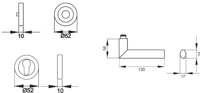
Der Türgriff Verona ER37 zeichnet sich durch sanftere und fließende Konturen aus, was durch den ovalen Hals unterstützt wird. Durch die 3-teilige Schraubrosette, wird eine einfache, schnelle und sichere Montage gewährleistet. Die Oberfläche in Edelstahl poliert verleiht eine elegante Optik aus hochwertigem Edelstahl.
