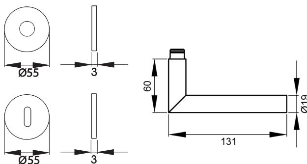
Das Modell Rhodos EPL28 ist der Klassiker schlechthin. Durch seine Geometrische Form, ist das Modell der Bestseller unter den Türgriffen. In Kombination mit der 3mm dünnen Plan Design Rosette, ist eine aufgesetzte oder flächenbündige Montage möglich. Die Farbe Titan Grau überzeugt durch seine matte Oberfläche und warm-graue Farbigkeit.
