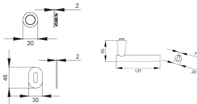
Ausschlaggebend für das Design des Türgriffmodells Brooklyn ER59M war das angestrebte Ziel „Invisibility“. Der Türgriff ist schmal gestaltet, streckt sich jedoch nach hinten flach zur Tür in eine Ebene aus. In Kombination mit der 2 mm dünnen Mi-ni-Rosette der Mission Invisible Reihe, liegt der Fokus auf dem Türgriff selbst. Die Farbe Polaris weiß lässt den Türbeschlag nahezu unsichtbar wirken, da sie sich in die koloristische Ebene einer weißen Türe nahtlos einfügt.
