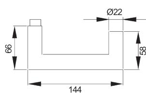
Angelehnt an das Modell Rhodos, besitzt der Türgriff Kos XL EP10 eine zur Tür laufende Handhabe und ist somit ebenfalls für Notausgangstüren geeignet. Durch die 3-teilige Schraubrosette, wird eine einfache, schnelle und sichere Montage gewährleistet. Die edelstahlmatte Farbe unterstreicht die Formgebung dieses Griffs.
