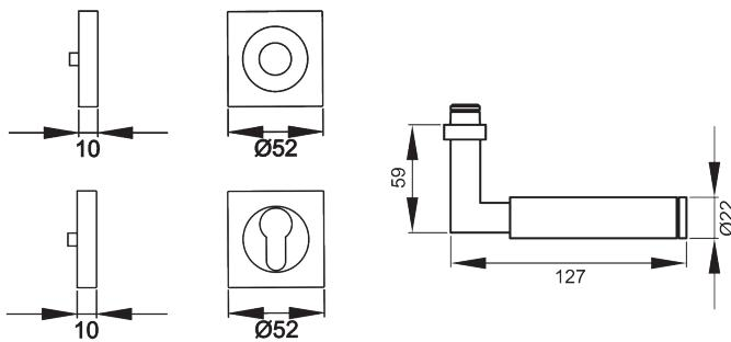
Die geometrischen Formen des Bauhausstils vereint in einem Türgriff -Tasmania ER31Q. Die runde Handhabe liegt gut in der Hand und hat zur Rosette hin einen eckigen Abschluss. Durch die 3-teilige Schraubrosette, wird eine einfache, schnelle und sichere Montage gewährleistet. Die edelstahlmatte Farbe unterstreicht die Formgebung dieses Griffs.
