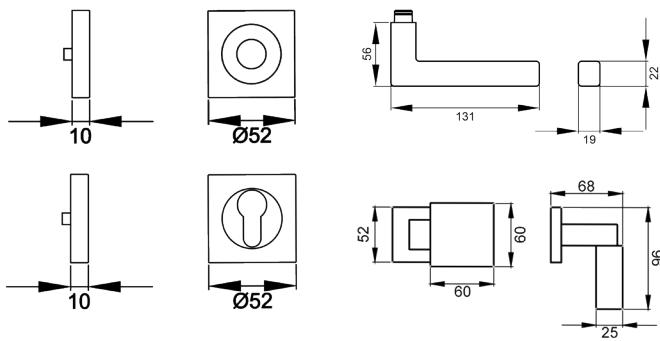
Quadratisch, schlicht und geradlinig ist das Designkonzept des Models ER46Q. Rational und minimalistisch folgt dieser Griff dem Trend zu geraden Linien. Durch die 3-teilige Schraubrosette, wird eine einfache, schnelle und sichere Montage gewährleistet. Die mehrfach prämierte seidenweiche Oberfläche Kosmos Schwarz, schafft eine unvergessliche Haptik.
