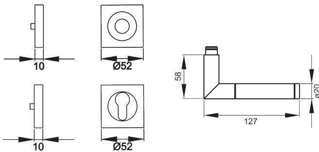
Der Türgriff Rio Steel ER34Q besitzt eine runde Handhabe, welche optisch durch zwei Vertiefungen nochmals unterteilt ist. Durch die 3-teilige Schraubrosette, wird eine einfache, schnelle und sichere Montage gewährleistet. Mit der hochwertigen Farbe Edelstahl matt/ poliert trifft zeitlose Eleganz auf edle Optik.
