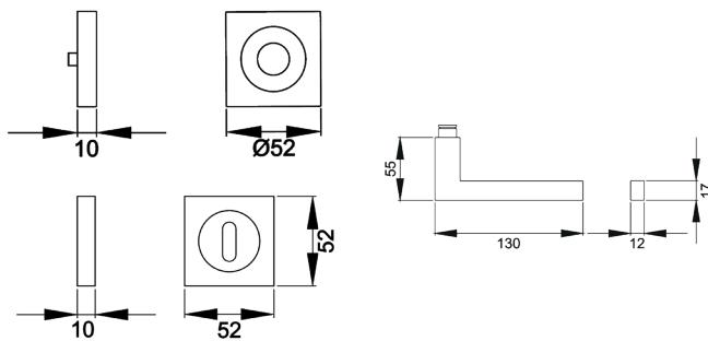
In einer Hommage an das sehr beliebte Türgriffmodell Seattle ER46Q wurde das Modell Boston ER58Q entwickelt. Hier sprechen gerade Formen für eine moderne Schlichtheit. Durch die 3-teilige Schraubrosette, wird eine einfache, schnelle und sichere Montage gewährleistet. Die mehrfach prämierte seidenweiche Oberfläche Kosmos Schwarz, schafft eine unvergessliche Haptik.
