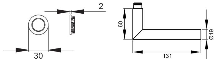
Das Modell Rhodos ER28M ist der Klassiker schlechthin. Durch seine Geometrische Form, ist das Modell der Bestseller unter den Türgriffen. In Kombination mit der 2 mm dünnen Mini-Rosette der Mission Invisible Reihe, liegt der Fokus auf dem Türgriff selbst. Die mehrfach prämierte seidenweiche Oberfläche Kosmos Schwarz, schafft eine unvergessliche Haptik.
