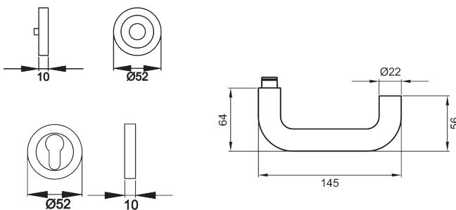
Der Türgriff Kreta XL ER17 hat eine zur Tür laufende Handhabe mit abgerundeten Ecken und ist somit ebenfalls für Notausgangstüren geeignet. Durch die 3-teilige Schraubrosette, wird eine einfache, schnelle und sichere Montage gewährleistet. Die edelstahlmatte Farbe unterstreicht die Formgebung dieses Griffs.
