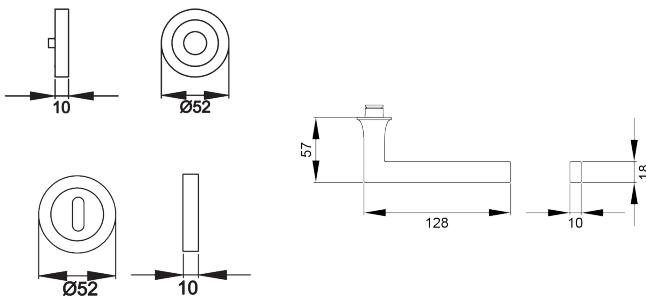
Beim Modell Soho ER57 werden klare Kanten durch gerundete Elemente aufgelöst. Dieses ausgewogene Formenspiel lässt den Türgriff ergonomisch in der Hand liegen. Durch die 3-teilige Schraubrosette, wird eine einfache, schnelle und sichere Montage gewährleistet. Die edelstahlmatte Farbe unterstreicht die Formgebung dieses Griffs.
