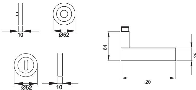
Die hervorgehobene Mittellinie des Türgriffs Chicago R220 machen dieses Modell zu einem besonderen Designobjekt. Durch die 3-teilige Schraubrosette, wird eine einfache, schnelle und sichere Montage gewährleistet. Die moderne Kombination aus Chrom und Chrommatt, unterstreichen dieses Modell.
