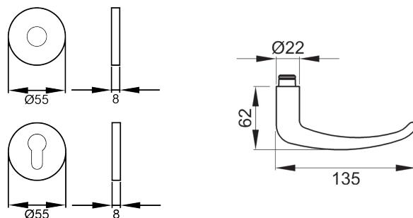
Ohne Ecken und Kanten. Der Türgriff Elba EPRO22 passt sich durch seine abgerundete Form der Handinnenseite an und verschafft so eine angenehme Haptik. Montiert auf der Performance Rosette, ist die EPR Technik DIE Lösung für robuste und starke Beanspruchung im Objektbereich. Die edelstahlmatte Farbe unterstreicht die Formgebung dieses Griffs.
