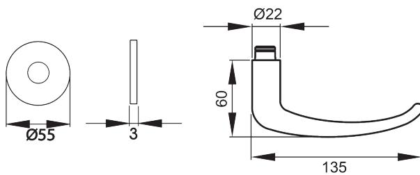
Ohne Ecken und Kanten. Der Türgriff Elba EPL22 passt sich durch seine abgerundete Form der Handinnenseite an und verschafft so eine angenehme Haptik. In Kombination mit der 3mm dünnen Plan Design Rosette, ist eine aufgesetzte oder flächenbündige Montage möglich. Die edelstahlmatte Farbe unterstreicht die Formgebung dieses Griffs.
