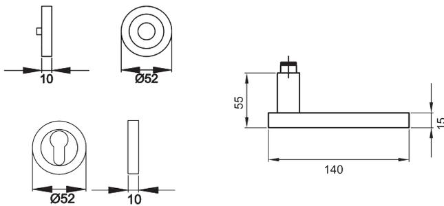
Der Türgriff TORINO R53 hat eine schlichte, rechteckige Handhabe. In die nur wenige Millimeter tiefe Aussparung auf können individuelle Inlays eingeklebt werden. Durch die 3-teilige Schraubrossette, wird eine einfache, schnelle und sichere Montage gewährleistet. Die mehrfach prämierte seidenweiche Oberfläche Kosmos Schwarz, schafft eine unvergessliche Haptik.
