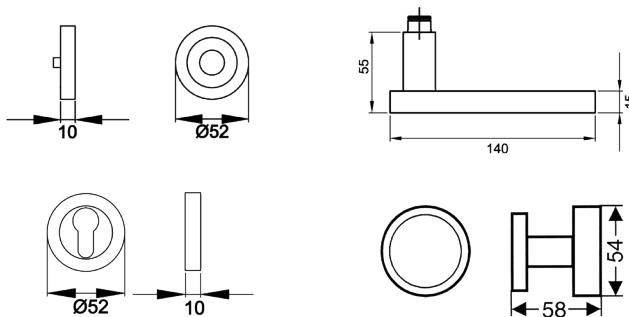
Der Türgriff Milano ER52 zeigt sich mit seinem kantigen Design, elegant und zeitlos. Durch die 3-teilige Schraubrosette, wird eine einfache, schnelle und sichere Montage gewährleistet. Die edelstahlmatte Farbe unterstreicht die Formgebung dieses Griffs.
