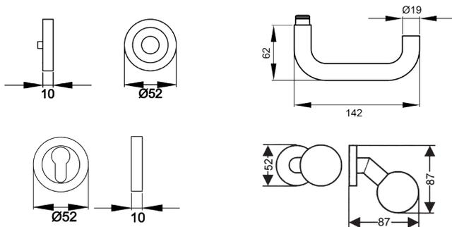
Der Türgriff Kreta ER27 hat eine zur Tür laufende Handhabe mit abgerundeten Ecken und ist somit ebenfalls für Notausgangstüren geeignet. Durch die 3-teilige Schraubrossette, wird eine einfache, schnelle und sichere Montage gewährleistet. Die edelstahlmatten Farbe unterstreicht die Formgebung dieses Griffs.
