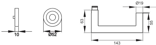
Angelehnt an das Modell Rhodos, besitzt der Türgriff Kos ER20 eine zur Tür laufende Handhabe und ist somit ebenfalls für Notausgangstüren geeignet. Durch die 3-teilige Schraubrosette, wird eine einfache, schnelle und sichere Montage gewährleistet. Die mehrfach prämierte seidenweiche Oberfläche Kosmos Schwarz, schafft eine unvergessliche Haptik.
