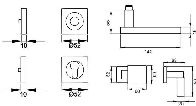
Der Türgriff TORINO R53Q hat eine schlichte, rechteckige Handhabe. In die nur wenige Millimeter tiefe Aussparung auf können individuelle Insets eingeklebt werden. Durch die 3-teilige Schraubrosette, wird eine einfache, schnelle und sichere Montage gewährleistet. Die Oberfläche in Chrom verleiht eine elegante und dennoch moderne Optik.
