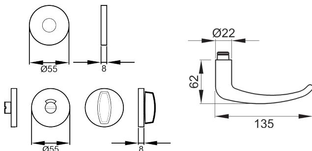
Ohne Ecken und Kanten. Der Türgriff Elba EPRO22 passt sich durch seine abgerundete Form der Handinnenseite an und verschafft so eine angenehme Haptik. Montiert auf der Performance Rosette, ist die EPR Technik DIE Lösung für robuste und starke Beanspruchung im Objektbereich. Die edelstahlmatte Farbe unterstreicht die Formgebung dieses Griffs.
