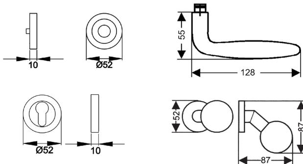
Mit seinem oval förmigen Griffende ist der Türgriff Korfu ER24 ein echter Komfort für die Hand. Durch die 3-teilige Schraubrossette, wird eine einfache, schnelle und sichere Montage gewährleistet. Die edelstahlmatten Farbe unterstreicht die Formgebung dieses Griffs.
