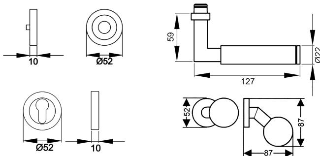
Die geometrischen Formen des Bauhausstils vereint in einem Türgriff -Tasmania ER31. Die runde Handhabe liegt gut in der Hand und hat zur Rosette hin einen eckigen Abschluss. Durch die 3-teilige Schraubrosette, wird eine einfache, schnelle und sichere Montage gewährleistet. Die edelstahlmatte Farbe unterstreicht die Formgebung dieses Griffs.
