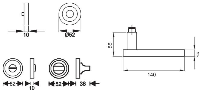
Der Türgriff TORINO R53 hat eine schlichte, rechteckige Handhabe. In die nur wenige Millimeter tiefe Aussparung auf können individuelle Insets eingeklebt werden. Durch die 3-teilige Schraubrosette, wird eine einfache, schnelle und sichere Montage gewährleistet. Die Oberfläche in Chrom verleiht eine elegante und dennoch moderne Optik.
