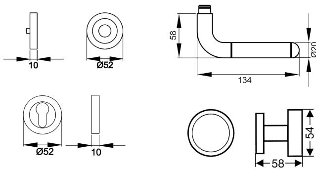
Die runde Form und ein abgerundetes Griffende charakterisiert den Türgriff Lignano ER35. Durch die 3-teilige Schraubrosette, wird eine einfache, schnelle und sichere Montage gewährleistet. Die edelstahlmatte Farbe unterstreicht die Formgebung dieses Griffs.
