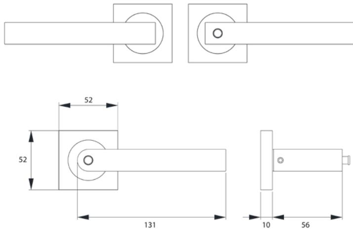
Quadratisch, schlicht und geradlinig ist das Designkonzept des Models ER46Q. Rational und minimalistisch folgt dieser Griff dem Trend zu geraden Linien. Durch einen Pin auf dem Türgriff selbst, ist das Verschließen Ihrer Türen ohne Bad- oder Schlüsselrosette möglich. Die edelstahlmatte Farbe unterstreicht die Formgebung dieses Griffes.
