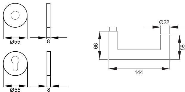
Angelehnt an das Modell Rhodos, besitzt der Türgriff Kos XL EPRO10 eine zur Tür laufende Handhabe und ist somit ebenfalls für Notausgangstüren geeignet. Montiert auf der Performance Rosette, ist die EPR Technik DIE Lösung für robuste und starke Beanspruchung im Objektbereich. Die edelstahlmatte Farbe unterstreicht die Formgebung dieses Griffs.
