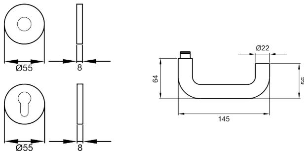
Der Türgriff Kreta XL EPRO17 hat eine zur Tür laufende Handhabe mit abgerundeten Ecken und ist somit ebenfalls für Notausgangstüren geeignet. Montiert auf der Performance Rosette, ist die EPR Technik DIE Lösung für robuste und starke Beanspruchung im Objektbereich. Die edelstahlmatte Farbe unterstreicht die Formgebung dieses Griffs.
