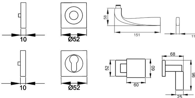
Der Türgriff Nevada ER88Q ist um seine eigene Achse gedreht und somit leicht nach unten gebogen. Er verläuft zum Griffende hin flach und ist durch klare Rundungen und Formen definiert. Durch die 3-teilige Schraubrosette, wird eine einfache, schnelle und sichere Montage gewährleistet. Die edelstahlmatten Farbe unterstreicht die Formgebung dieses Griffs.
