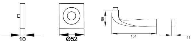
Der Türgriff Nevada ER88Q ist um seine eigene Achse gedreht und somit leicht nach unten gebogen. Er verläuft zum Griffende hin flach und ist durch klare Rundungen und Formen definiert. Durch die 3-teilige Schraubrosette, wird eine einfache, schnelle und sichere Montage gewährleistet. Die edelstahlmatte Farbe unterstreicht die Formgebung dieses Griffs.
